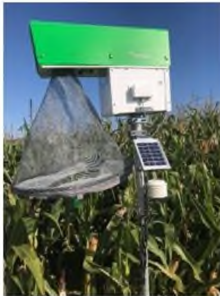
Slika 3: Elektronska past Trapview za spremljanje pojava koruzne vešče
